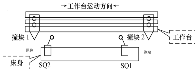
图1-6.1 工作台运动方向示意图
